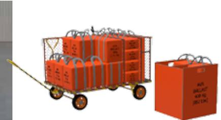
El kit de lastres se utiliza en una aeronave para lograr el centro de gravedad (GC) deseado, cuando el centro de gravedad no está dentro de los límites o no está en la ubicación deseada por el operador.
