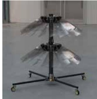
Estructura multifuncional para el almacenamiento y ejecución de actividades de mantenimiento en las palas o alabes del motor de la aeronave.
