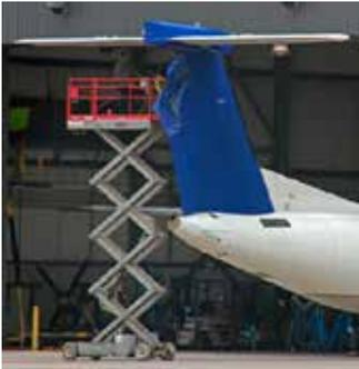
El dispositivo electrónico de proximidad DTMA, evita los daños estructurales causados a la aeronave, debido a posibles impactos con el equipo de apoyo en tierra en los servicios de mantenimiento
