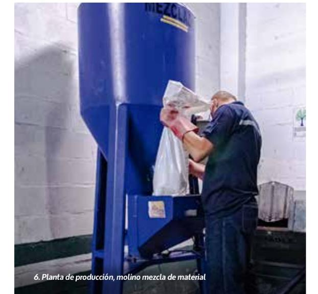
6. Planta de producción, molino mezcla de material
