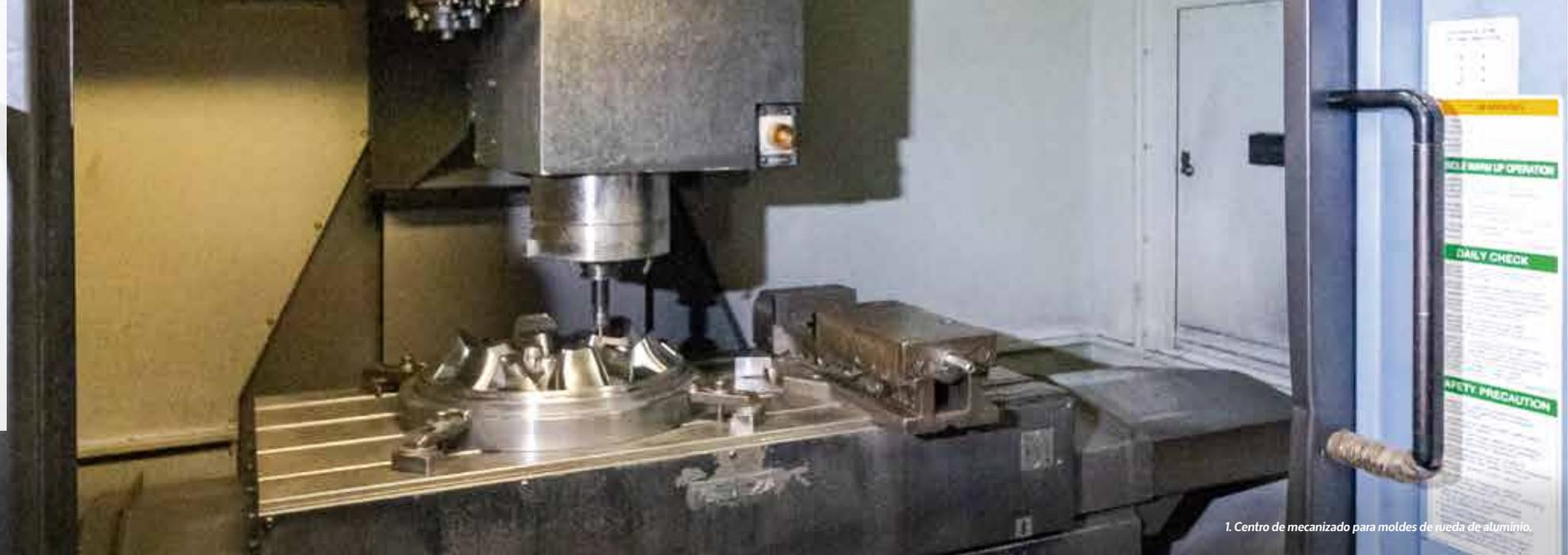
1. Centro de mecanizado para moldes de rueda de aluminio.
