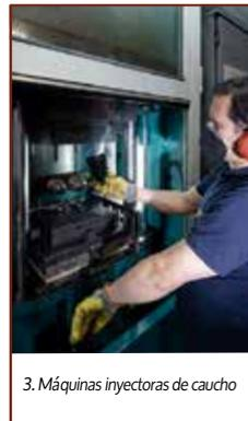
3. Máquinas inyectoras de caucho
