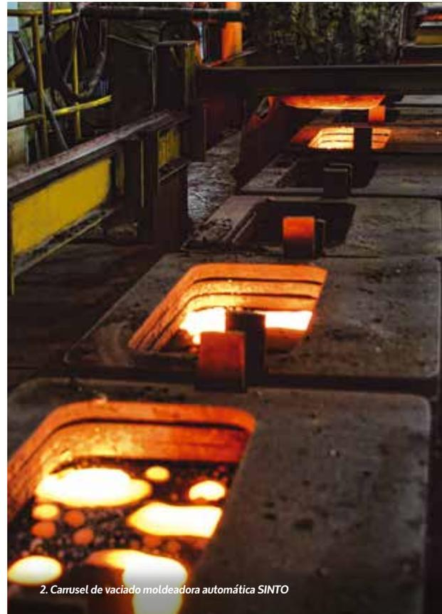
2. Carrusel de vaciado moldeadora automática SINTO
