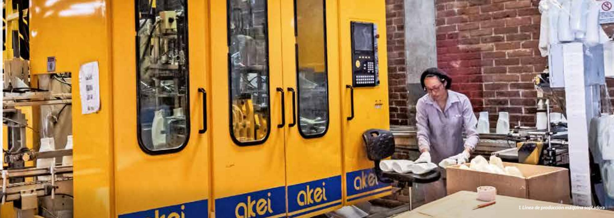
1. Línea de producción máquina sopladora
