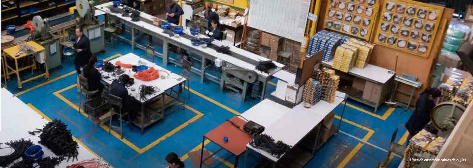
1. Línea de ensamble cables de bujías
