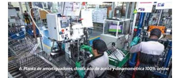
6. Planta de amortiguadores, dosificado de aceite y dinamométrica 100% online
