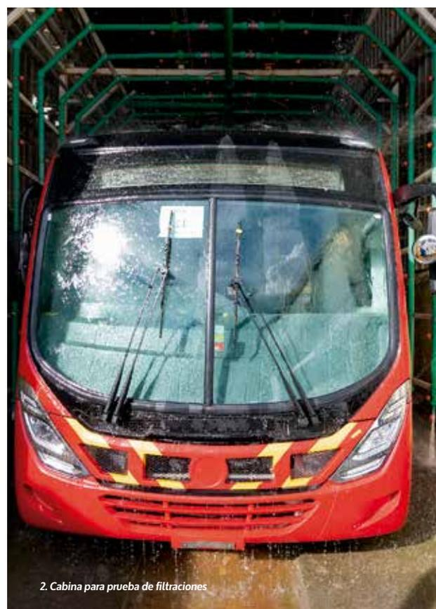
2. Cabina para prueba de filtraciones
