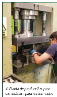
4. Planta de producción, prensa hidráulica para conformados
