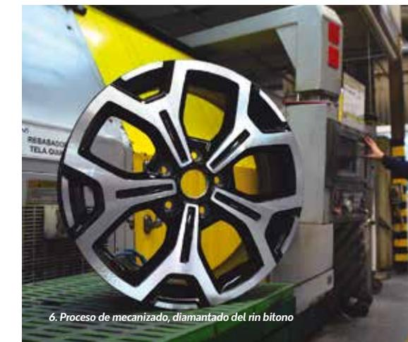
6. Proceso de mecanizado, diamantado del rin bitono
