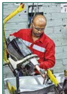
3. Planta de producción, pinza de soldadura de proyección
