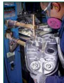
5. Planta producción, línea de soldadura de punto
