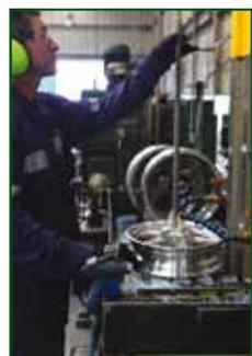
4. Línea de rin moto, fabricación del estriado interno del rin moto (brocado)
