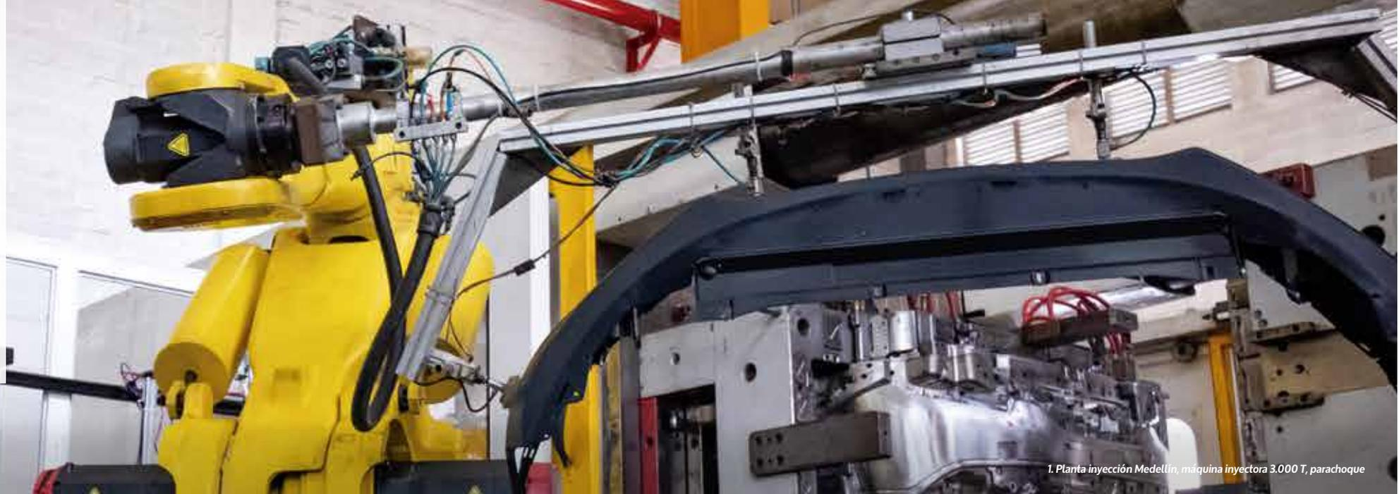
1. Planta inyección Medellín, máquina inyectora 3.000 T, parachoque
