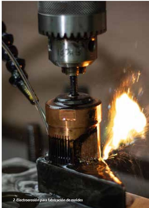
2. Electroerosión para fabricación de moldes
