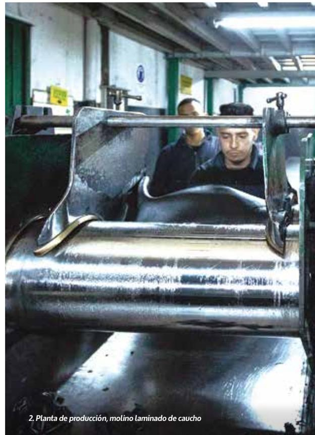
2. Planta de producción, molino laminado de caucho
