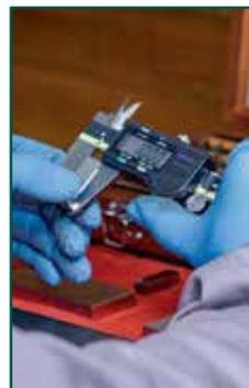
4. Retoque, identificación e inspección final helicoidales
