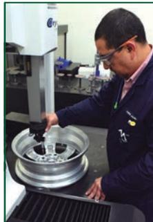
3. Proceso de calidad, mediciones en máquina de coordenadas
