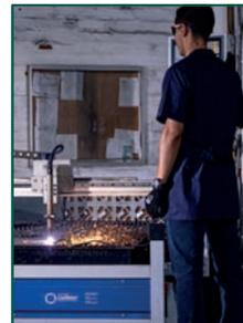
4. Planta de producción. Corte de lámina
