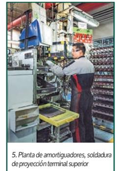
5. Planta de amortiguadores, soldadura
