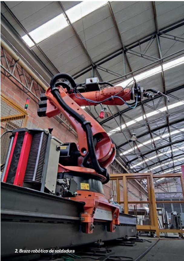
2. Brazo robótico de soldadura
