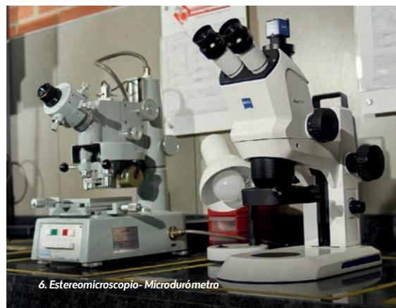
6. Estereomicroscopio- Microdurómetro
