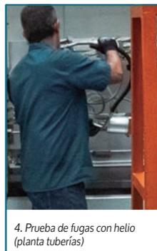
4. Prueba de fugas con helio (planta tuberías)
