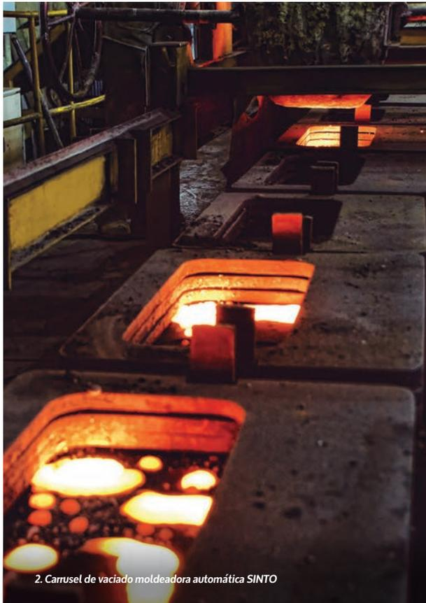
2. Carrusel de vaciado moldeadora automática SINTO
