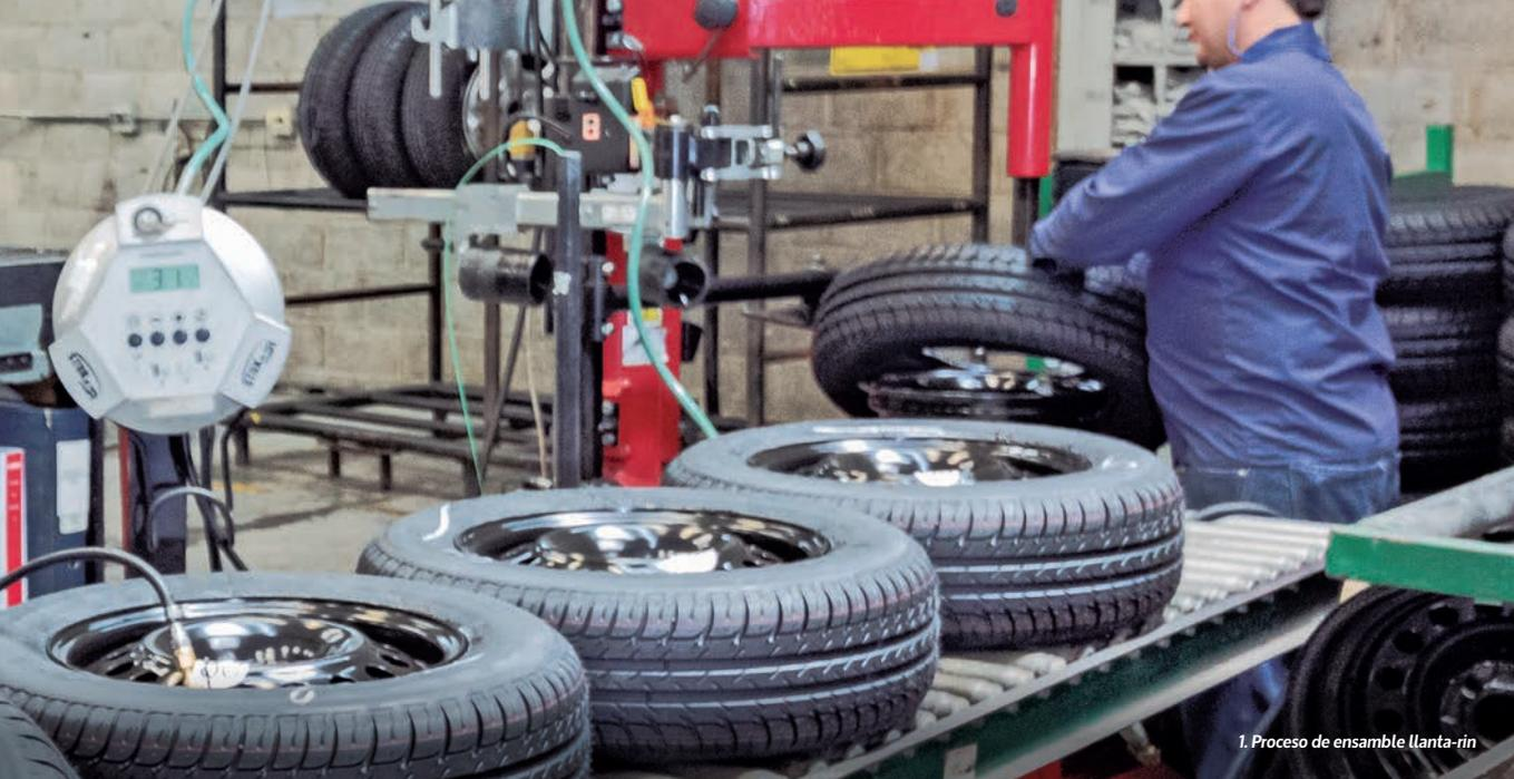
1. Proceso de ensamble llanta-rin
