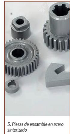
5. Piezas de ensamble en acero sinterizado
