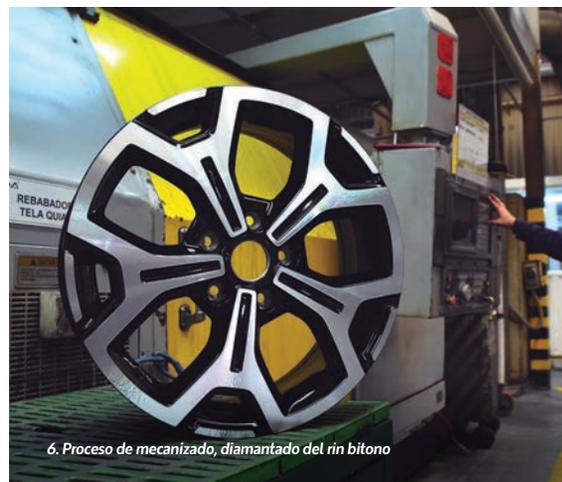
6. Proceso de mecanizado, diamantado del rin bitono
