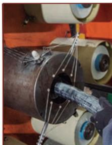
3. Máquina extrusora y tejedoras de mangueras
