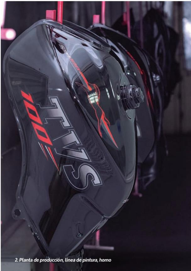
2. Planta de producción, línea de pintura, horno
