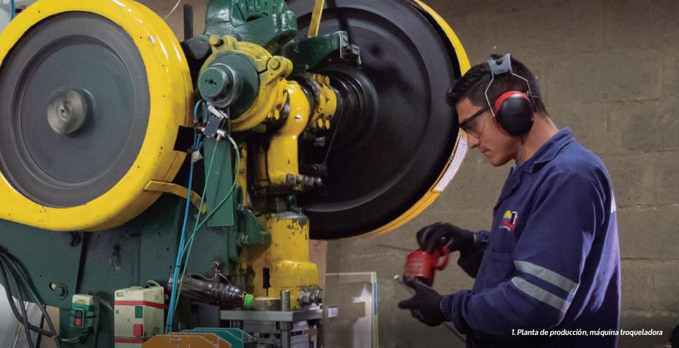
1. Planta de producción, máquina troqueladora
