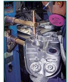
5. Planta producción, línea de soldadura de punto
