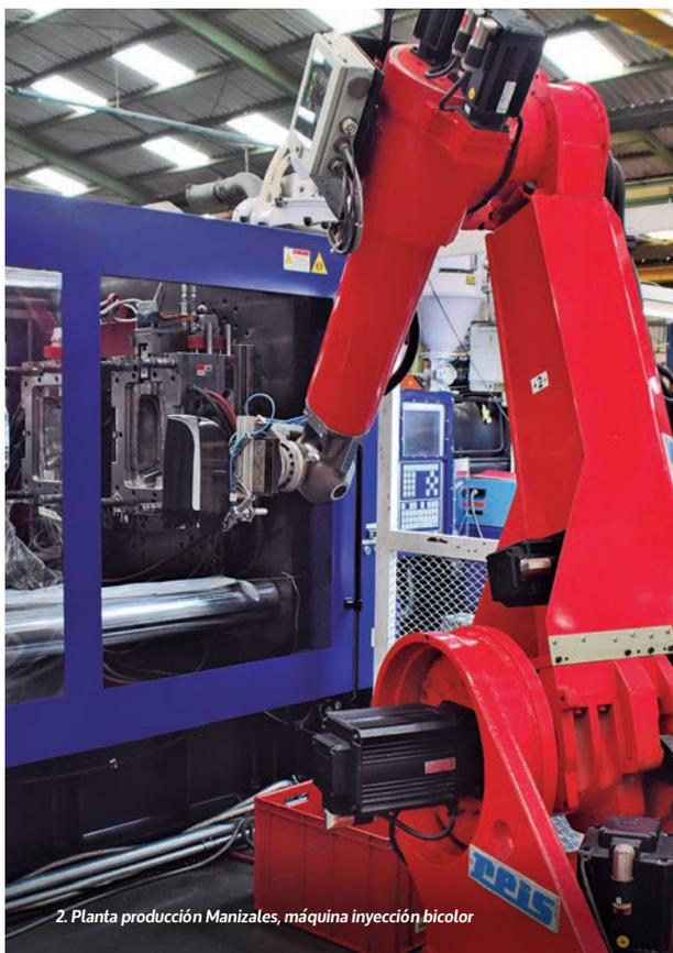
2. Planta producción Manizales, máquina inyección bicolor
