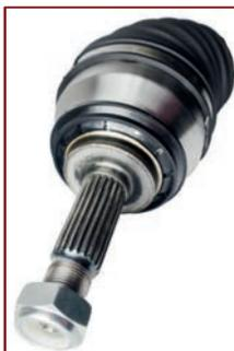
4. Junta fija ensamblada
