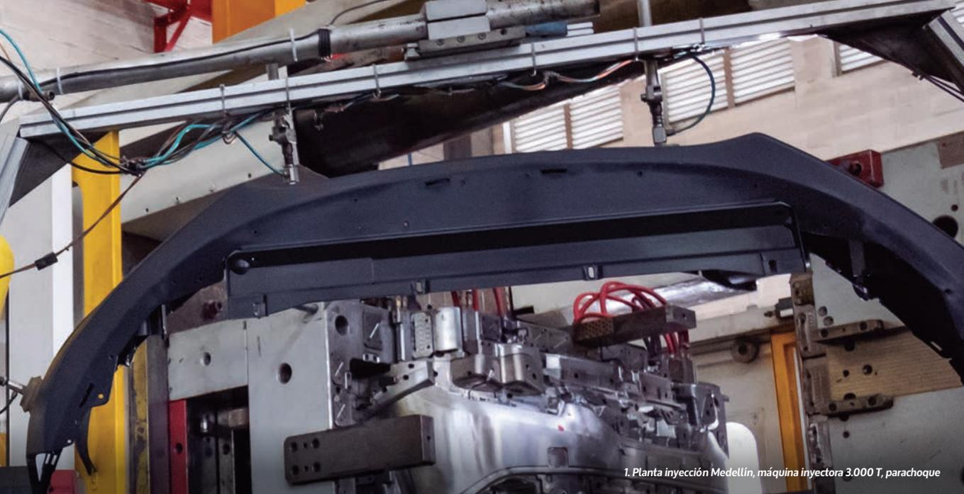
1. Planta inyección Medellín, máquina inyectora 3.000 T, parachoque
