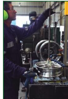
4. Línea de rin moto, fabricación del estriado interno del rin moto (brocado)
