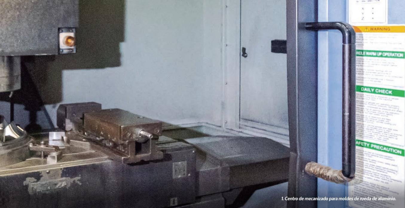
1. Centro de mecanizado para moldes de rueda de aluminio.
