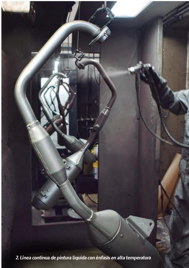
2. Línea continua de pintura líquida con énfasis en alta temperatura
