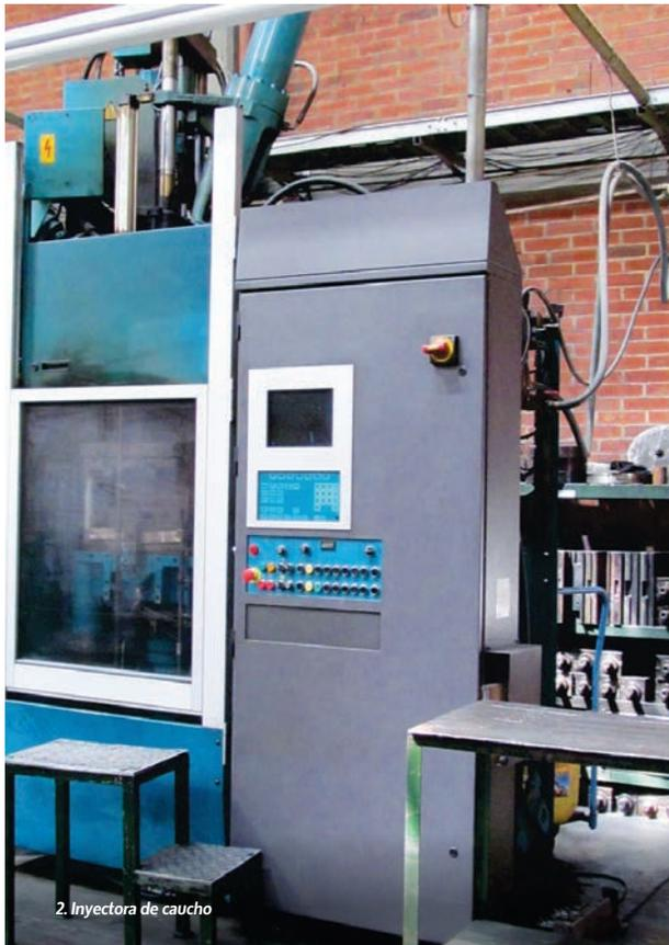
2. Inyectora de caucho
