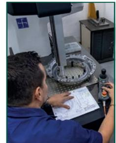
5. Laboratorio. Máquina de medición por coordenadas (CMM)
