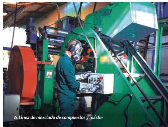
6. Línea de mezclado de compuestos y máster
