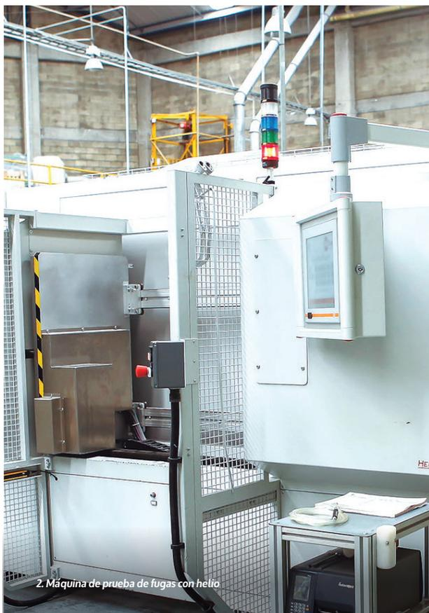
2. Máquina de prueba de fugas con helio
