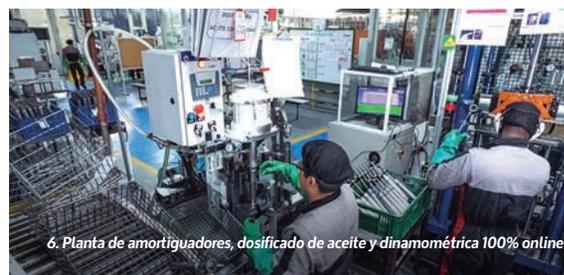
6. Planta de amortiguadores, dosificado de aceite y dinamométrica 100% online
