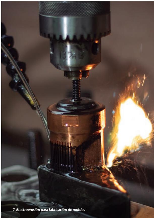
2. Electroerosión para fabricación de moldes
