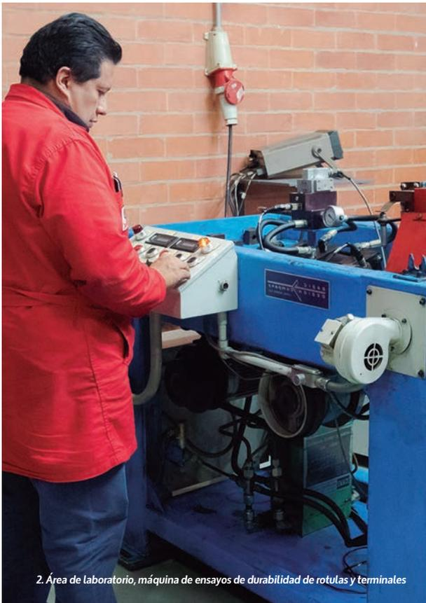
2. Área de laboratorio, máquina de ensayos de durabilidad de rotulas y terminales
