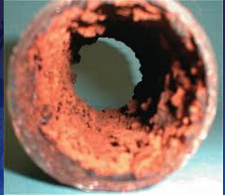
Fig. Tubería C.S. en servicio con aire húmedo, origina demanda artificial
