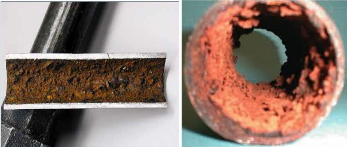
Fig.12 Rugosidad incrementada y reducción de diámetro interior de tubería CS en servicio con aire húmedo, origina demanda artificial.
